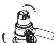
6. Frånkoppling av reglaget från cylinderventilen: Sätt spaken i OFF-position, lyft låsringen och ta bort reglaget.
