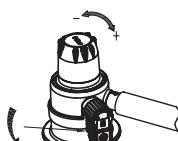
6. Säätimen irrottaminen sylinteriventtiilistä: Käännä vipu OFF-asentoon, nosta lukkorenkaas ja poista säädin.
