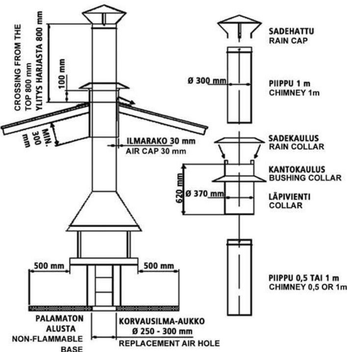
**FI** Varmista piippuliitokset peltiruuvilla tai poraavalla peltiruuvilla (2kpl). Myös kuumankestäävä liimamassaa voi käyttää.
