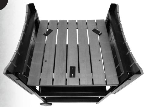
1) Aseta polttimen kiinnityslatat kuvan mukaisesti puitason reikiin. Huomaa, että kaksi puitason reikää jää käytämättä. Kiinnitä latta ruuviilla ja tason alta siipimutterilla. Muista lisätä prikit molemminkin puolin ruuvia ja latan väliin. Älä kiristä ruuveja vielä tässä vaiheessa loppuun, latta saa liikkua hieman. Tämä liikkumavara helpottaa polttimen paikalleen asettamista.
