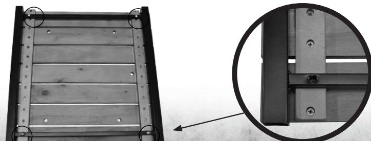
**KESKITASOJEN KIINNITYS • MONTERING AV MELLERSTA HYLLORNA • FASTENING THE MIDDLE SHELVES • КРЕПЛЕНИЕ СРЕДНЕЙ ПЛОСКОСТИ • KESKMISE LAUA JA RIUILITE KINNITAMINE KÄRU KÜLJERAAMI KÜLGE • BEFESTIGUNG DER MITTELFÄCHEN**
